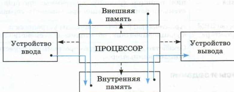
Рис. 2.12. Структура однопроцессорной ЭВМ. Сплошные стрелки — передача данных, пунктирные стрелки — управляющее воздействие
